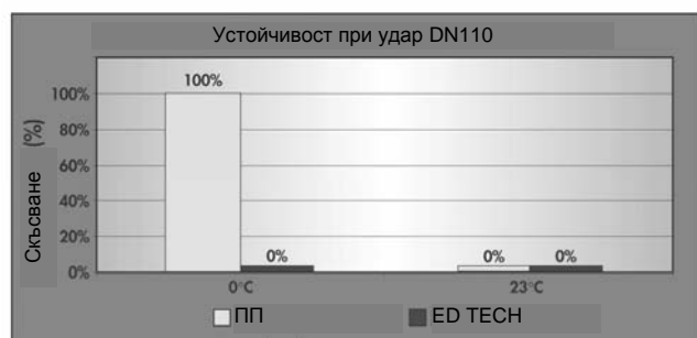
Фиг. 2: Диаграма на температурна устойчивост на Wavin Ed спрямо обикновена ПП тръба
